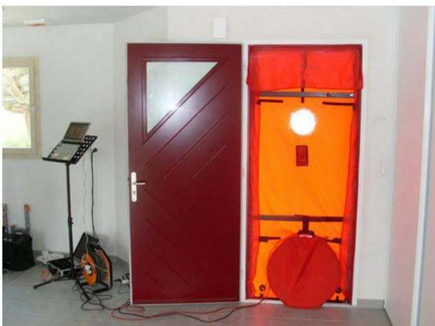
De nombreux constructeurs se sont dotés d'une Blower-Door pour tester l'étanchéité de leur maison avant la réalisation du test d'étanchéité effectué avant la livraison de la construction.
